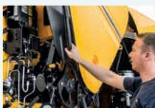
L'ampio carter anteriore monoblocco permette di accedere facilmente a tutte le parti mobili e ai componenti di lubrificazione e ingrassaggio automatici.
