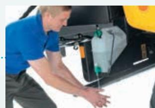
Il pacchetto comfort comprende un corrimano di servizio sul lato destro della piattaforma, una cassetta porta attrezzi extralarge e un serbatoio dell'acqua per il lavaggio delle mani.
