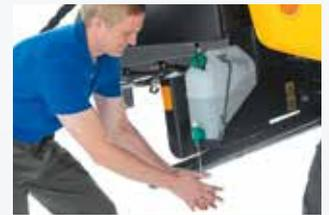
Das Komfortpaket umfasst einen Handlauf auf der rechten Seite der Serviceplattform, einen großen Werkzeugkasten und einen Wasserbehälter für die Handwäsche.
