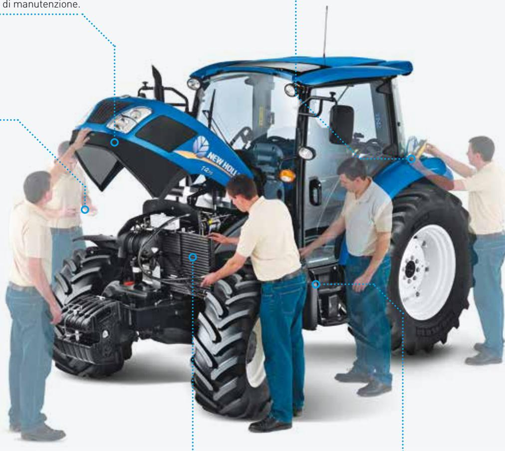
Il modulo di raffreddamento si estrae tramite una guida scorrevole e può essere pulito in modo rapido e semplice.
