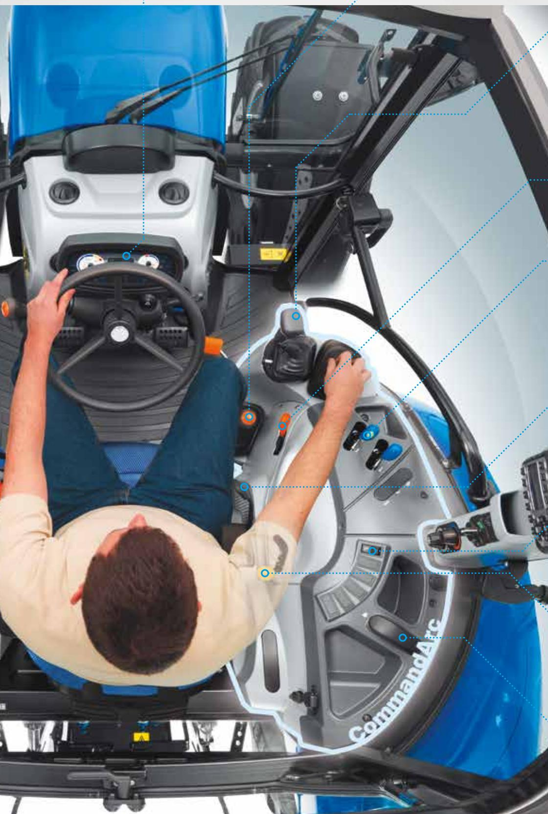
L'acceleratore elettronico permette di calibrare con precisione la velocità d'avanzamento del trattore.
