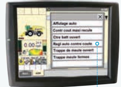
Réglage automatique en cabine du contre-couteau
