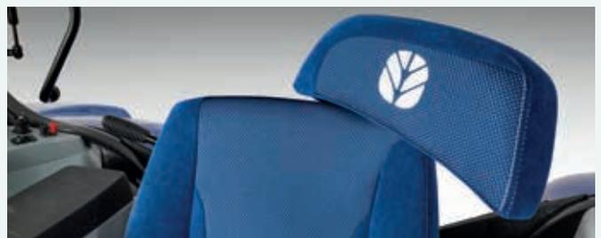
Sowohl die Auto Comfort™, die Dynamic Comfort™- als auch die Comfort-Sitze verfügen über eine schwenkbare Rückenlehne, die der oberen Rückenpartie zusätzlichen Halt gibt und den Komfort erheblich verbessert, wenn der Sitz zum Kontrollieren der Heckanbaugeräte gedreht wird.
