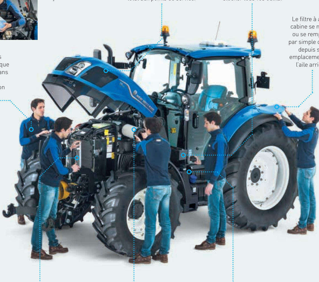
Le bloc de refroidissement coulisse latéralement pour un nettoyage facile et efficace.
