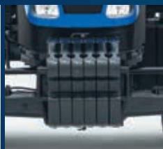
Le bloc de refroidissement coulisse latéralement pour un nettoyage facile et efficace.
