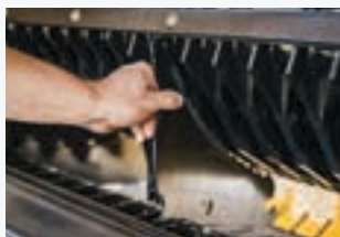
Nouveau racleur de rotor pour améliorer le flux de la récolte et réduire la consommation de carburant.
