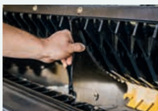
Neuer Rotorabstreifer für verbesserten Erntegutfluss und geringere Leistungsaufnahme.
