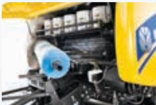
Portarotoli integrato per facilitare la sostituzione delle bobine di rete da terra.
