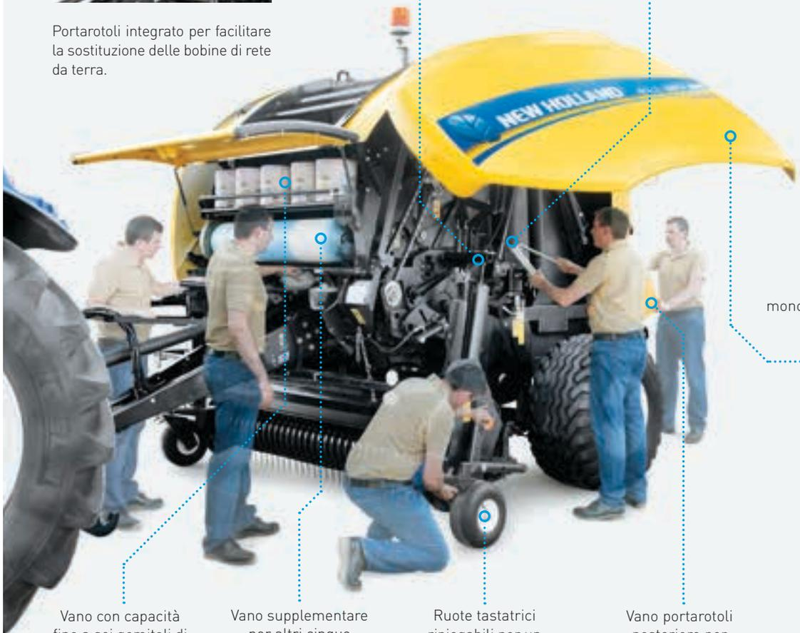
Carter laterali monostruttura autoportanti ad ali di gabbiano per facilitare l'assistibilità.
