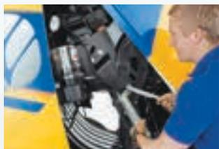
L'ampio carter anteriore monoblocco permette di accedere facilmente a tutte le parti mobili e ai componenti di lubrificazione e ingrassaggio automatici.
