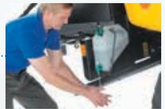
Das Komfortpaket umfasst einen Handlauf auf der rechten Seite der Serviceplattform, einen großen Werkzeugkasten und einen Wasserbehälter für die Handwäsche.
