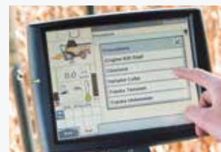
L'intera parte interna della mietitrebbia può essere pulita utilizzando la funzione Cleanout. I crivelli, i controbattitori e il battitore vengono interamente puliti. Ideale per il passaggio da una coltura a un'altra o quando si esegue la raccolta di una coltura da seme.
