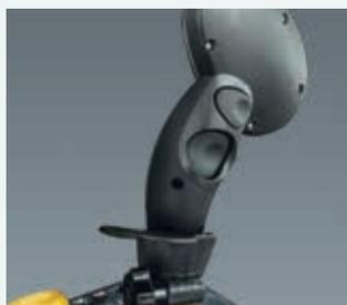
Déverrouillage de l'avancement (derrière).
