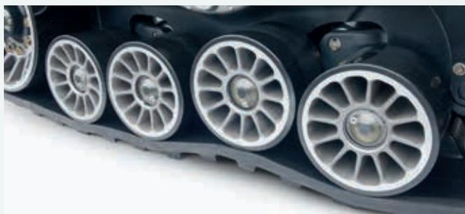
Deux paires de galets à suspension hydraulique agissent indépendamment pour offrir une conduite en douceur et sans à coup. Les déplacements routiers sont encore plus sûrs avec ces galets oscillants qui épousent parfaitement les ondulations de la route. Une plus grande longueur de chenilles procure une plus grande empreinte au sol et un tassement réduit.
