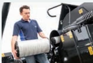
Der Luftfilter ist von der Motorplattform aus leicht zugänglich.
