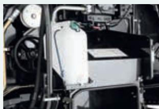
Der integrierte Wassertank ist an der idealen Stelle zum Händewaschen angebracht.
