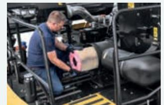
Der Luftfilter ist von der Motorplattform aus leicht zugänglich.
