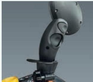
Umschalttaste und Entsperrung des Fahrhebels (hinten).
