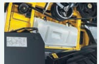
Die Kunststoff-Rotorabdeckungen können ohne Werkzeug demontiert werden.
