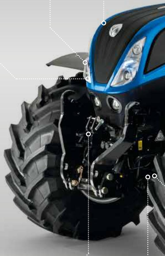
Sollevatore anteriore con una capacità di sollevamento fino a 3.568 kg
