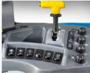
Neue Bedienhebelsperre für mehr Sicherheit.
