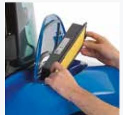
Der Kabinenluftfilter kann einfach gewechselt werden.
