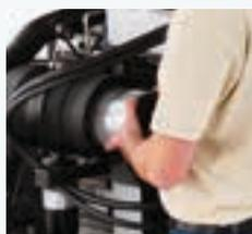
Le filtre à air du moteur est facile à vérifier, nettoyer ou remplacer, sans outil.
