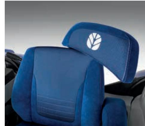
Sowohl der Dynamic Comfort™- als auch der Comfort-Sitz verfügen über eine neue Schwenkfunktion, die der oberen Rückenpartie zusätzlichen Halt gibt und den Komfort erheblich verbessert, wenn der Sitz gedreht ist, um die Heckanbaugeräte zu kontrollieren.
